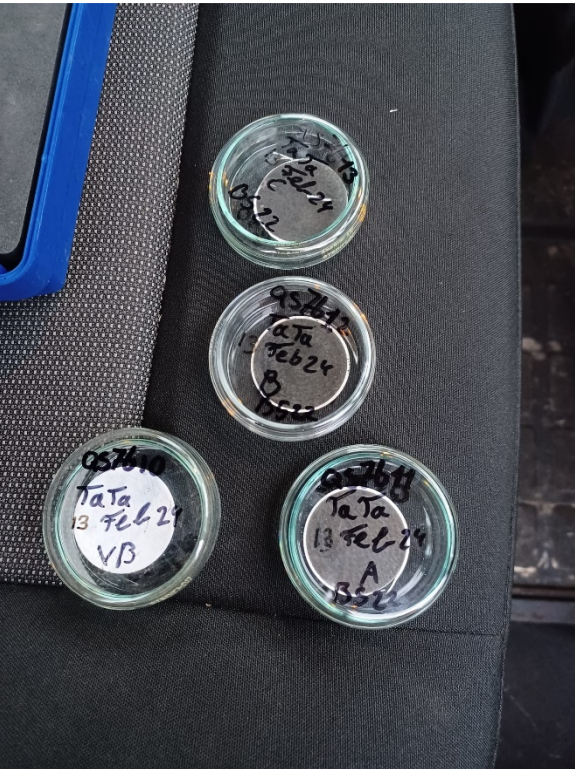
Figuur 1: foto stoffilters BS22 veldblanco (VB) en deelmetingen A, B en C
