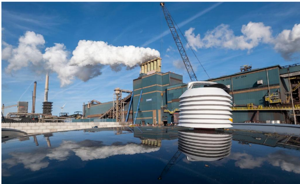
Figuur 15: De Omgevingsdienst beschikt ook over mobiele eNoses voor controles op en rondom het Tata terrein.
