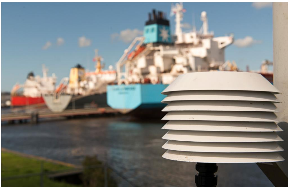
Figuur 16: Voor het opsporen van varend ontgassende schepen zijn 55 eNoses langs de vaarwegen geplaatst.
